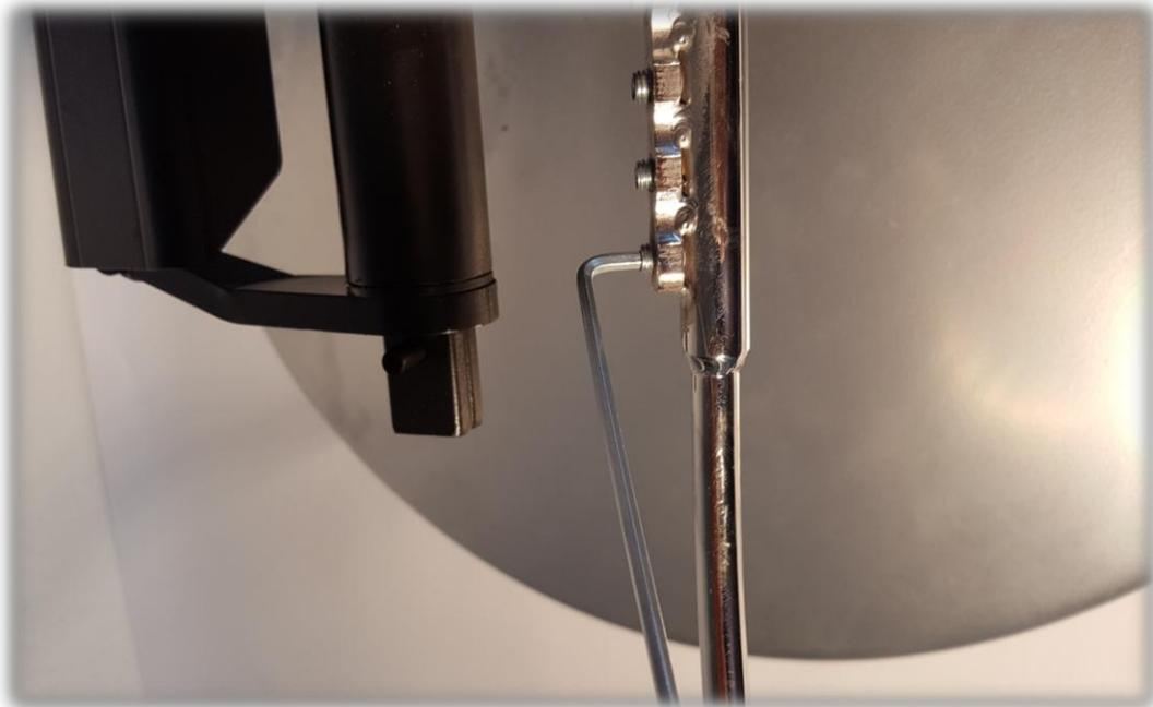
Das 0,5mm Feinblech zwischen Klemmblech und Bremsbelag stecken und die Klemmschraube mit der Spannmutter leichtl verspannen dass das Feinblech nicht hinunter fällt.
