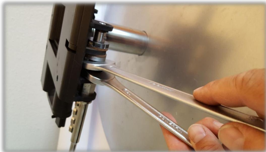
Nach dem das Feinblech entfernt wurde und die Klemmmutter gekontert wurde sollte geprüft werden, das sich die Klemmschraube leicht mit der Hand drehen lässt.
