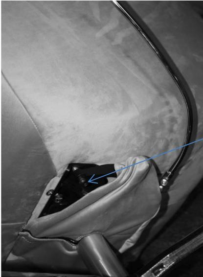
Die Wippfunktion kann mittels Einstellschraube justiert werden.
