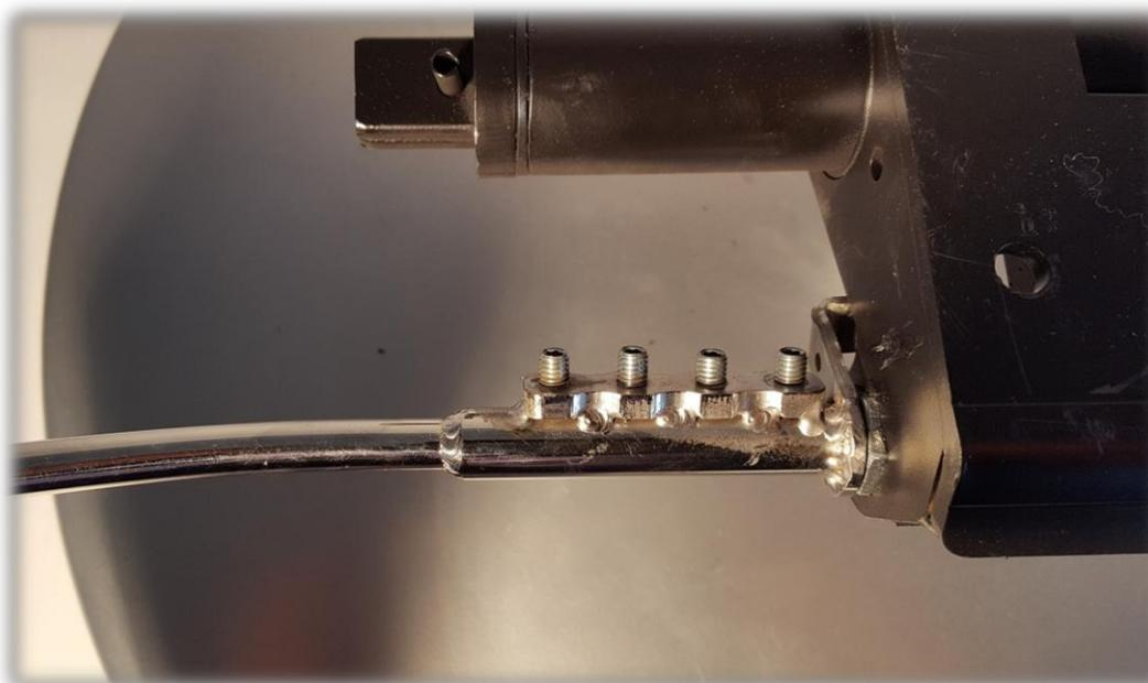
Vier Gewindestifte M6x12mm mit dem Imbusschlüssel festziehen mit ca. 8 Nm
