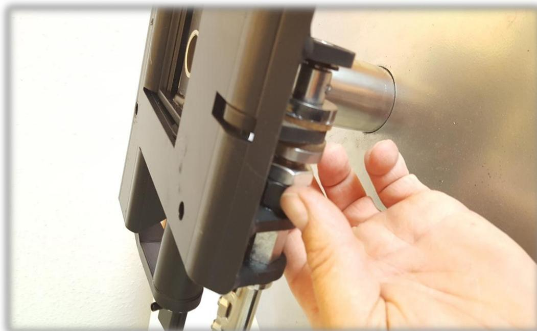
Bei der Wippe mit dem montierten Verriegelungshebel kann jetzt der Sitzrahmen aufgeschraubt werden.
